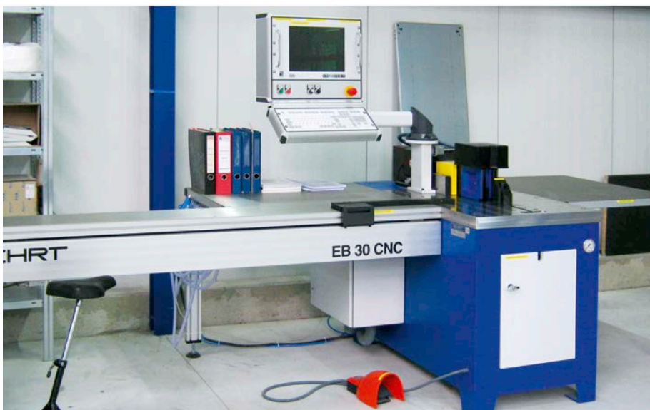
CNC-gesteuerte Biegemaschine zur Kupferschienenbiegung inkl. Rückfederungskompensation
