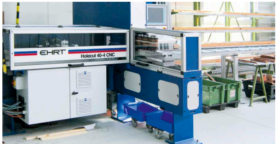
CNC-gesteuerte Stanze zur Kupferschienenbearbeitung mit Werkzeugwechselsystem
